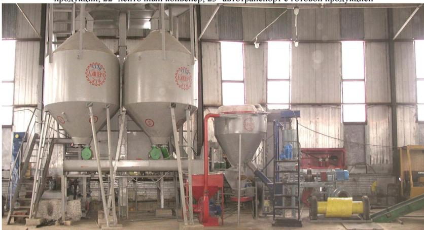
Рис. 5. Опытно-промышленный технологический комплекс для производства экструдированных техногенных материалов
