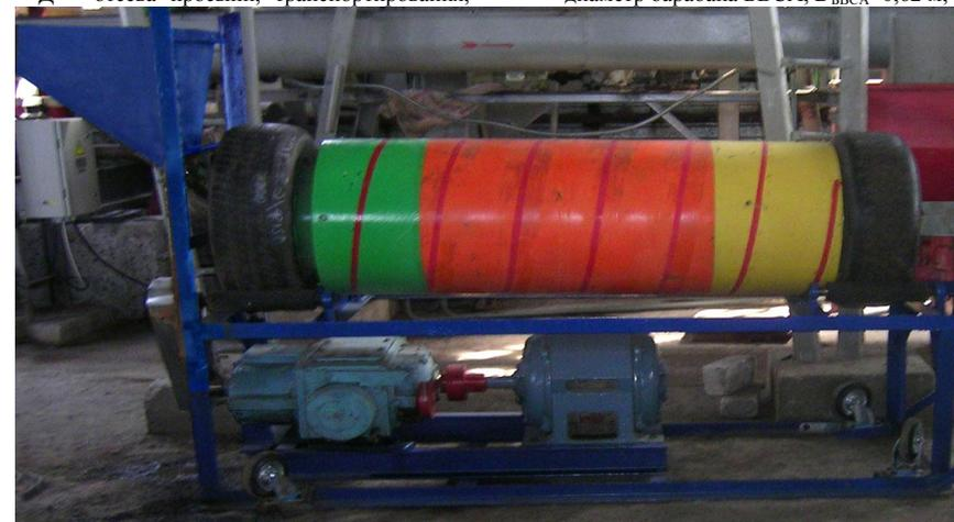
Рис. 6. Барабанно-винтовой сушильный агрегат комбинированного действия
